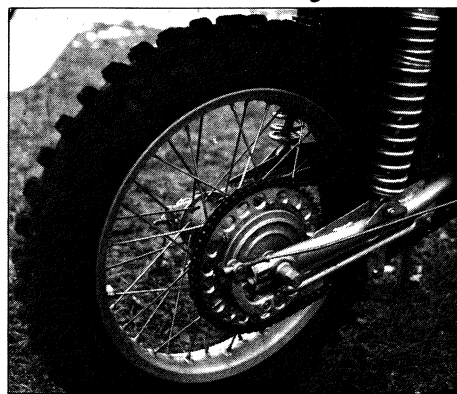
Die hinteren Stoßdämpfer der Hercules-Sachs. Koni-Gasdruckdämpfer mit 185 mm Federweg
