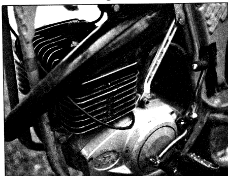
Der 125er KTM-Motor hatte erst vor einem Jahr Premiere. Auch er recht kompakt ohne allzu große Verrippung. Der Auspuff geht durch den Rahmen und wechselt auf die rechte Seite. Bei der Hercules bleibt er links. Fotos: Poensgen
