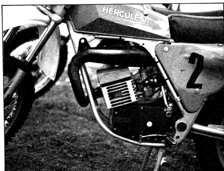
Der neue Sachs-Zylinder wirkt recht kompakt. Keine großen Kühlrippen mehr, was auch nicht nötig ist.
