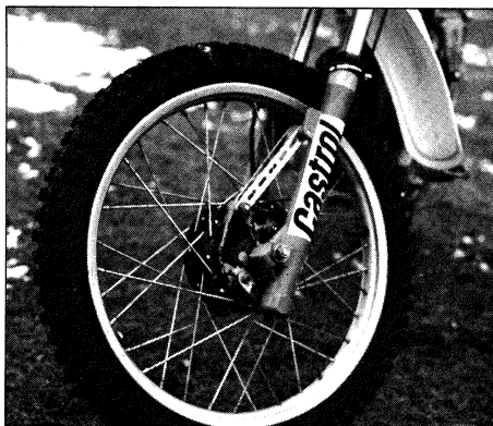
Ab 1977 wird die Marzocchi-Telegabel (240 mm Federweg) serienmäßig eingebaut.
