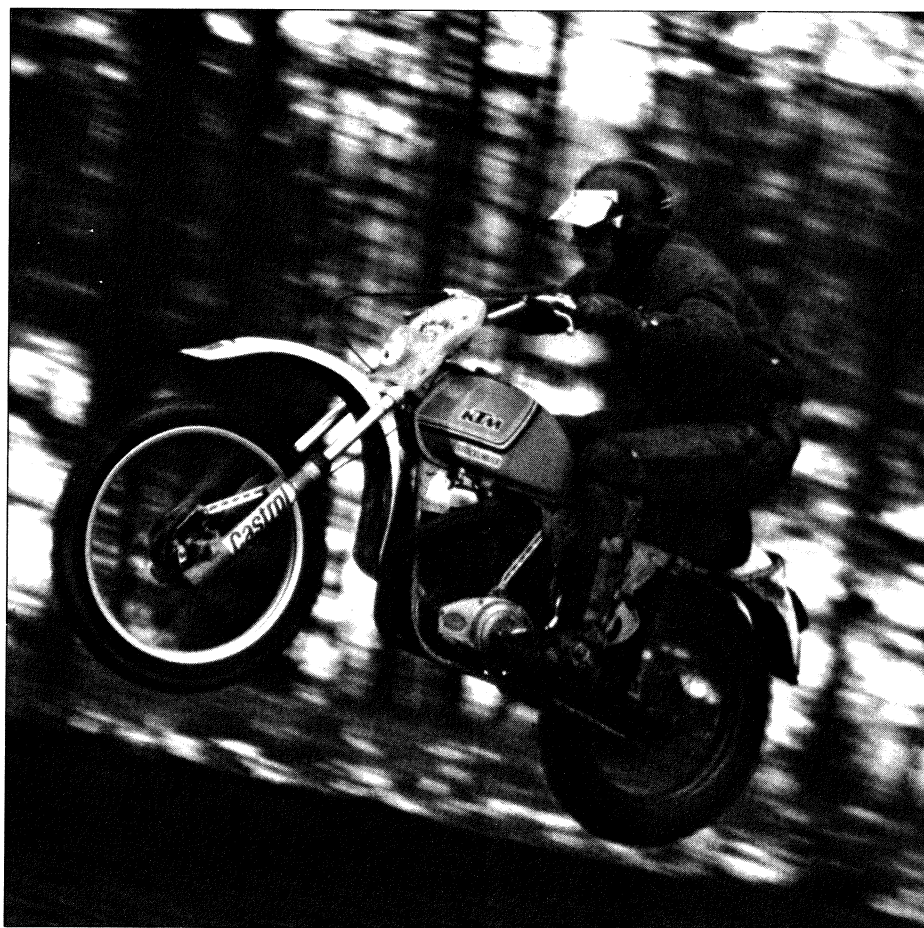
Ab 1977 wird die Marzocchi-Telegabel (240 mm Federweg) serienmäßig eingebaut.
